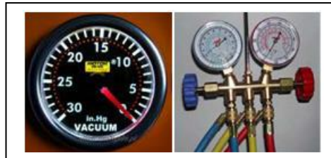
شكل (10): وصلات شحن مركبة والمانوميتر
