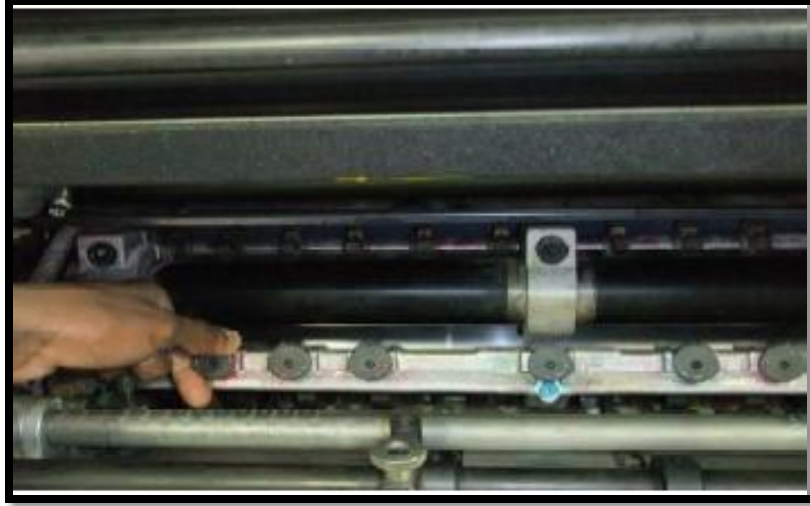
شكل (24) يبين تحريك الأدلة الأمامية لضبط طبعة الظهر على الوجه
