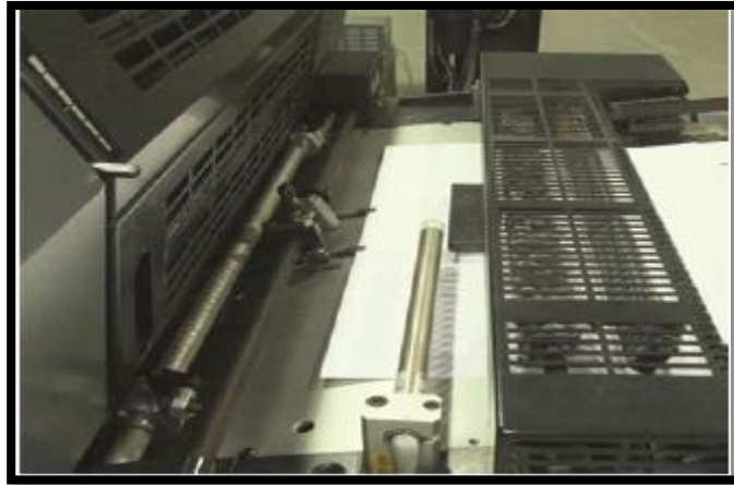
شكل رقم (4) يبين حساس الورق الإلكتروني
