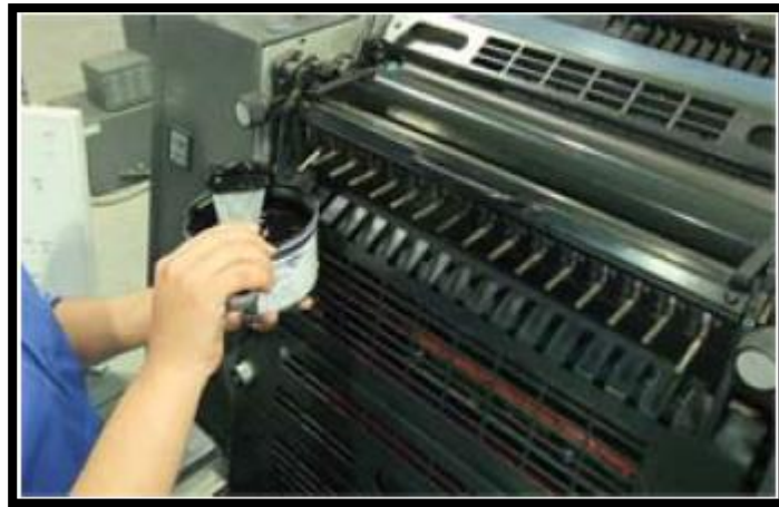
شكل رقم (16) يبين وضع الحبر في حوض الحبر
