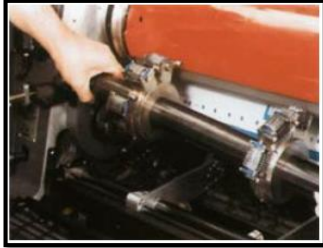
شكل رقم (35) يبين تركيب عمود حمل البكرة في ماكينة الأوفست
