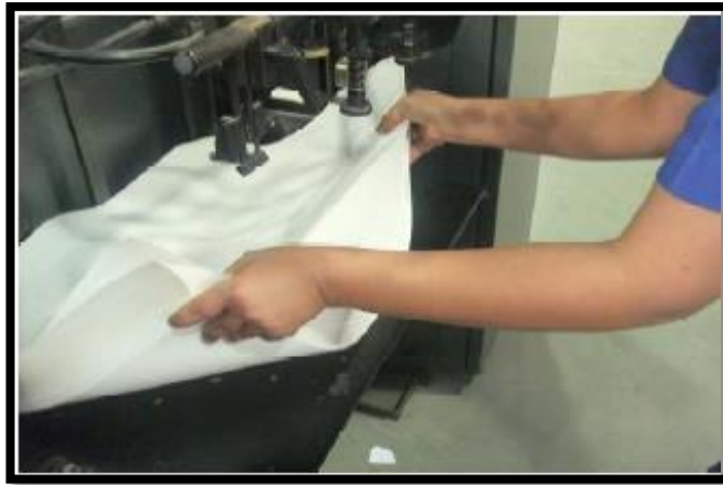
شكل رقم (23) يبين طريقة إعادة وطرق الورق المطبوع
