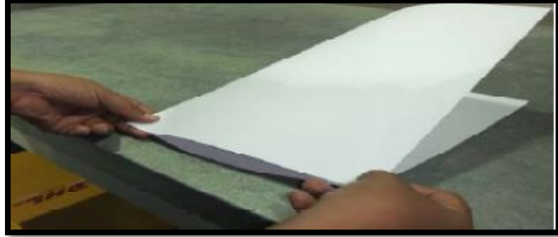
شكل رقم (19) يبين ثني الورقة من المنتصف لضبط الطبعة
