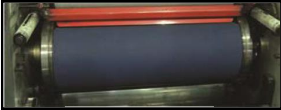
شكل رقم (14) يبين نظافة الوسيط المطاطي
