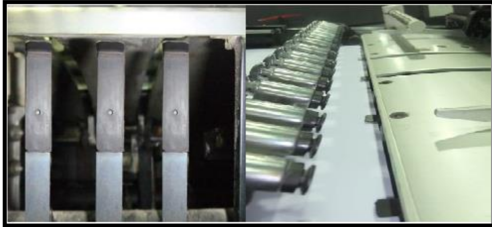
شكل رقم (6) يبين وضع ريش التمشيط
