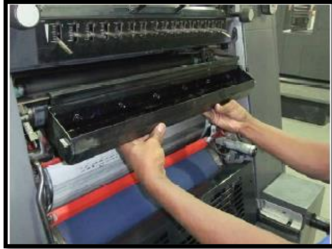
شكل رقم (27) يبين طريقة تركيب حوض الغسيل
