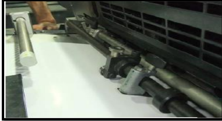
شكل رقم (11) يبين حركة سير الورق
