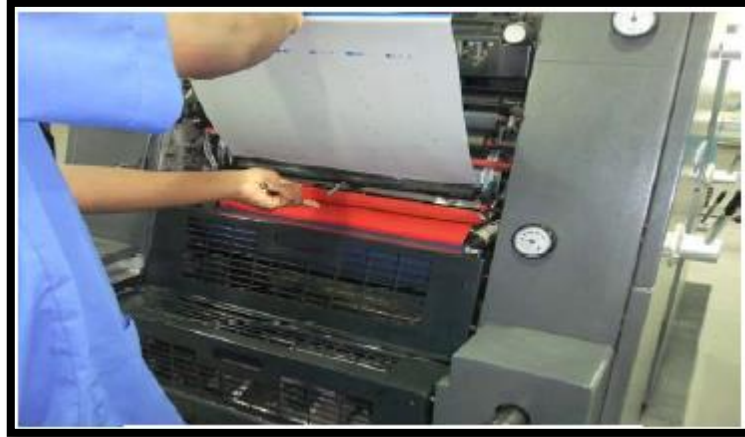
شكل رقم (13) يبين تركيب السطح الطباعي
