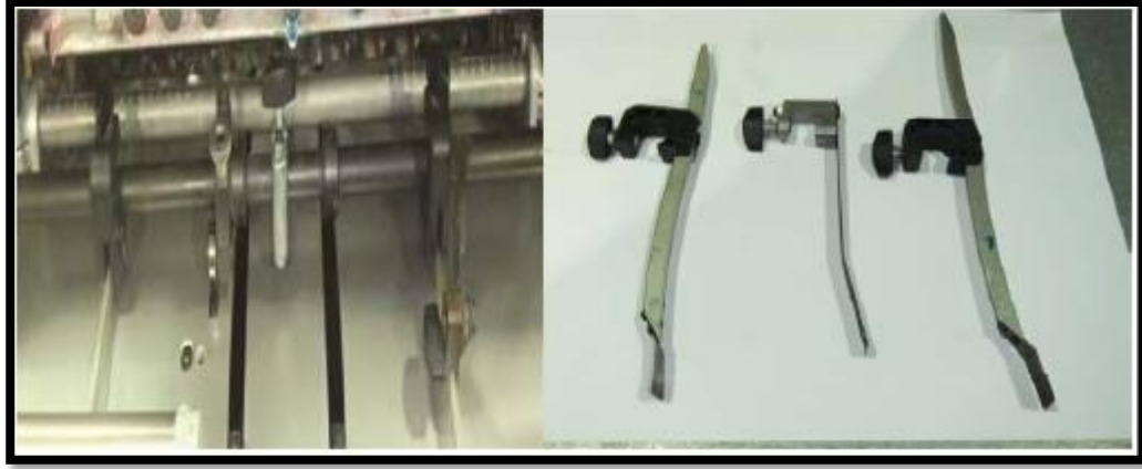
شكل رقم (7) يبين ريش التثبيت وموقع تركيبها
