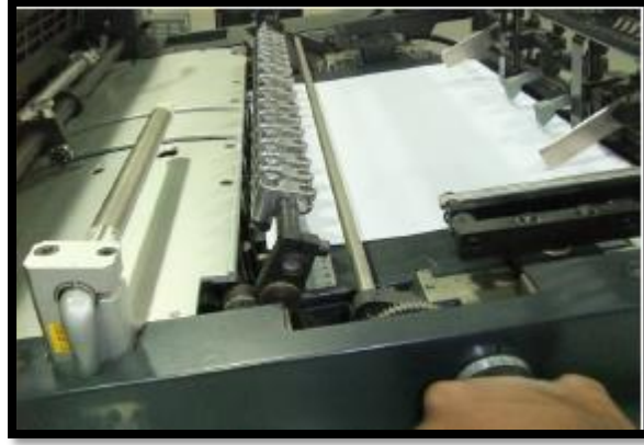
شكل رقم (3) يبين حساس التحكم في الطاولة
