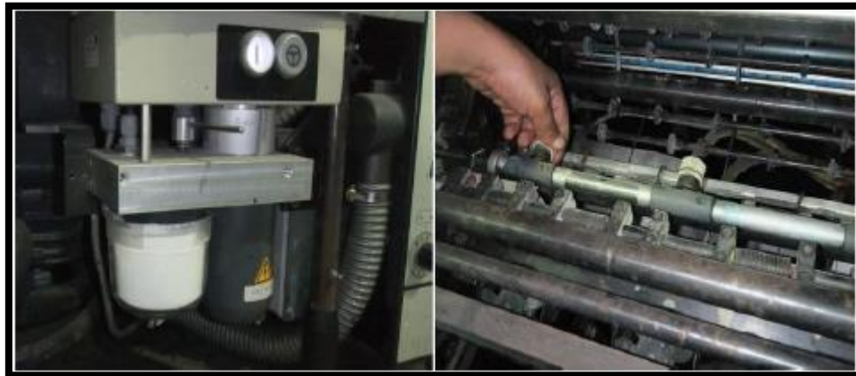
شكل رقم (18) يبين كمية البودرة في جهاز البودرة ويبين توزيع البودرة على حسب العمل
