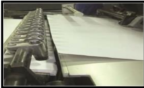
شكل رقم (2) يبين شفاطات الورق
