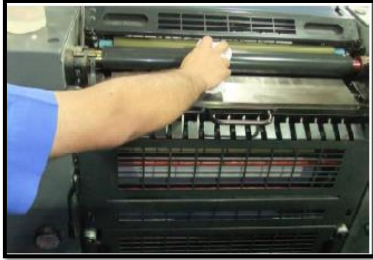
شكل (26) يبين تنظيف حوض الحبر بعد الانتهاء من طبع الظهر
