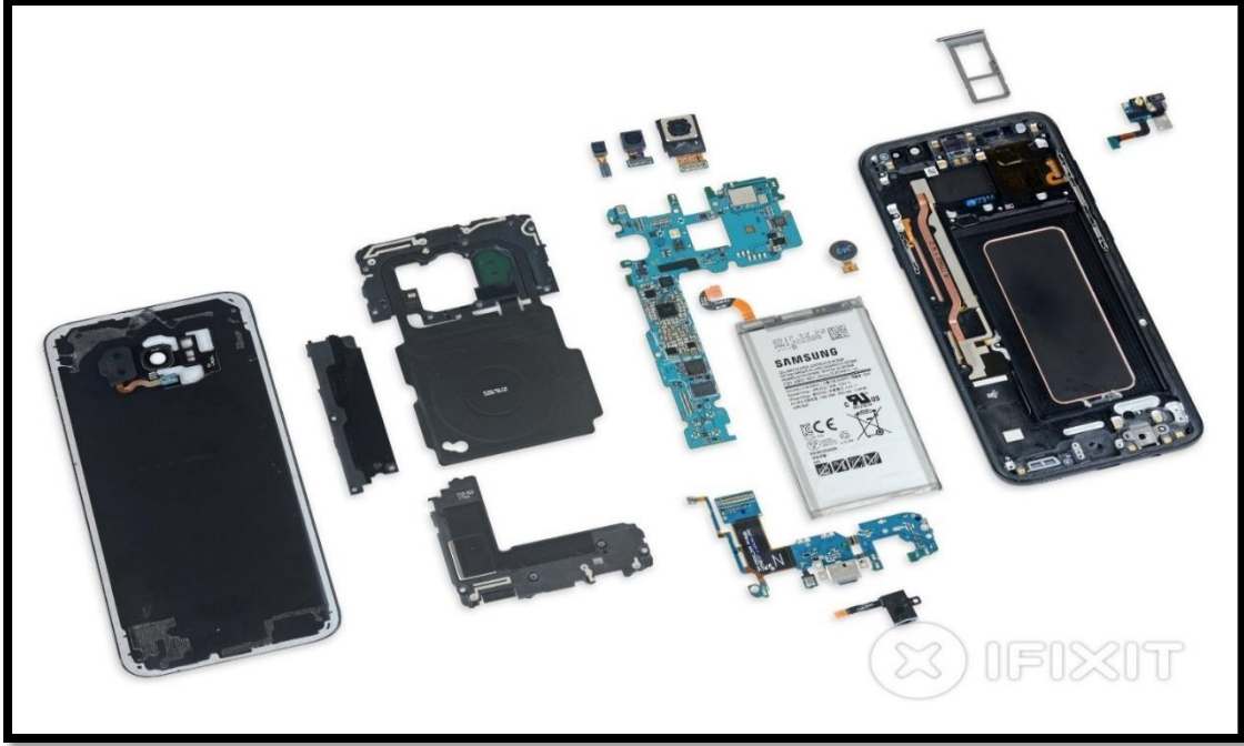
-11- المكونات الرئيسية لجهاز samsung g950f
